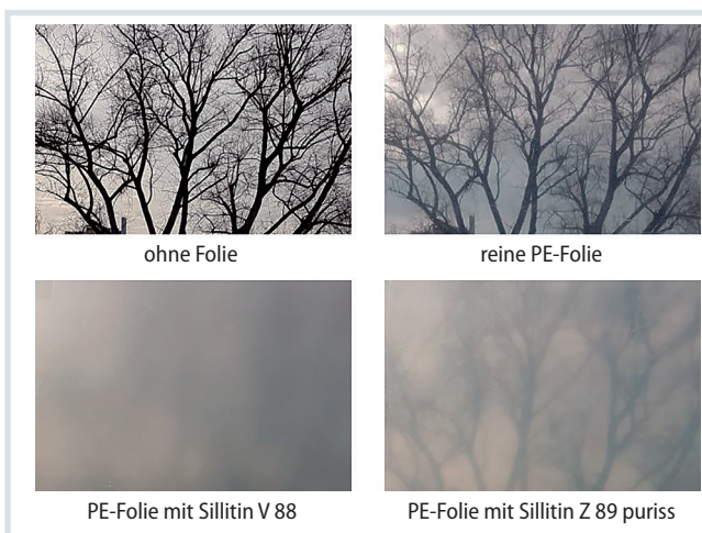
Bild 2. Durch Zugabe der Füllstoffe werden die PE-LD-Folien deutlich milchiger. Je größer die Partikel der Neuburger Kieselerde, desto milchiger wirkt die Folie. © Hoffmann Mineral
