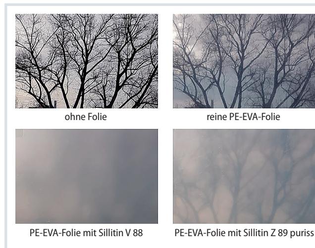
Bild 5. Die Füllstoffe sorgen bei PE-EVA-Folien ebenfalls für ein milchigeres Erscheinungsbild. Auch bei diesen hängt das Erscheinungsbild und die Trübung von der Größe der Füllstoffpartikel ab.
